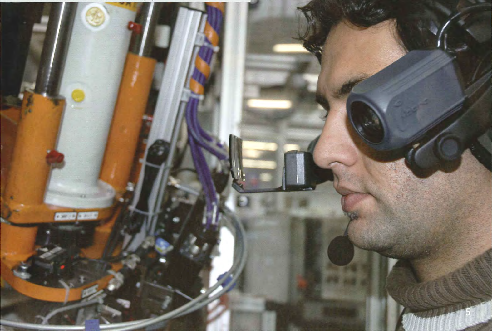
Das Headset mit Kamera, Mikrofon und Display
