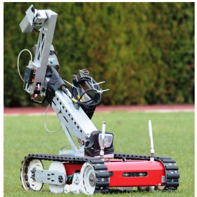
Roboter auf der Suche nach einer ausgebrachten Strahlungsquelle (Gemeinsame Übung mit der Berufsfeuerwehr Wien)
